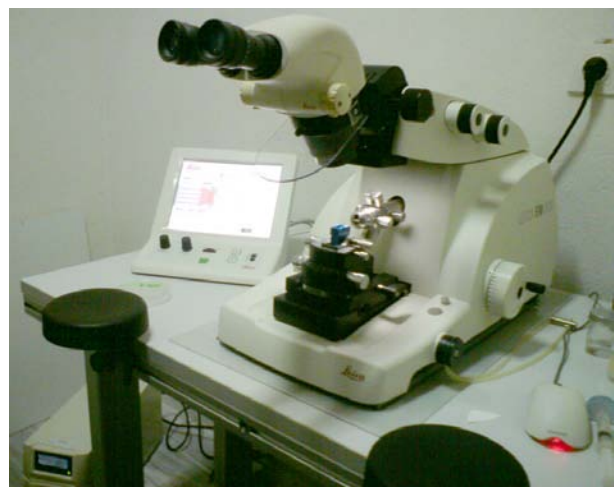
Εικόνα 2-6. Υπερμικροτόμος ηλεκτρονικού μικροσκοπίου. Ο ιστός διαποτίζεται με σκληρό υλικό (εποξική ρητίνη ή πολυακρυλικό) και μπορεί να κοπεί σε τομές πάχους από 20nm έως 1μm με κατάλληλα γυάλινα ή διαμαντένια μαχαίρια (Φυσιολογία, Τμήμα Ιατρικής Πανεπιστημίου Κρήτης).
